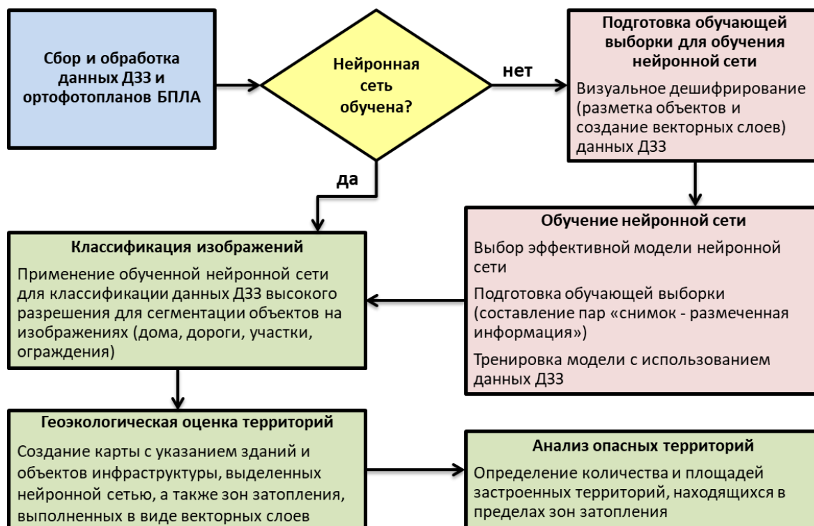
Рисунок 5 – Структурно–логическая схема комплексирования данных ДЗЗ из космоса и с БПЛА для автоматизированной идентификации зданий и объектов инфраструктуры
